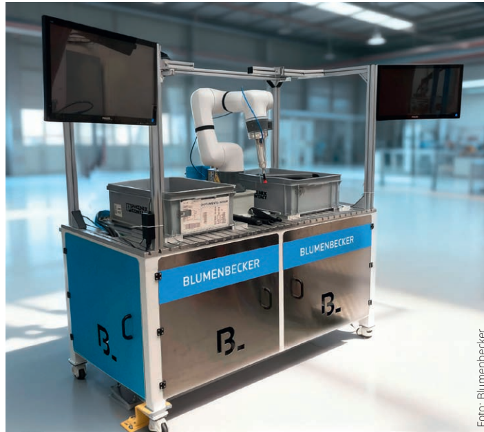
B.AI, die KI-gesteuerte Roboterzelle für flexible Teileentnahme.
