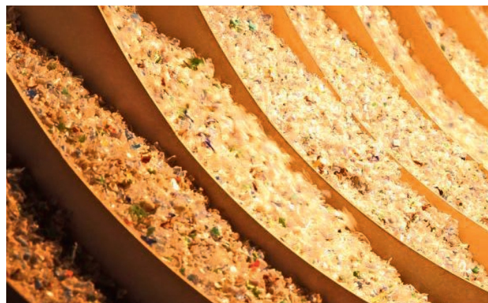
Blick ins Innere der Maschine von Kreyenborg, in der gerade recyceltes Material von PET-Flaschen behandelt wird.
